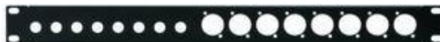
RCP-8715U CHAPA RACK CONECTORES DE HIERRO CON 1 UNIDAD 8 XLR-SPEAKON tipo-D, 8 JACK 6.3 mm o RCA Hembra ANCHURA : 483 mm ALTURA : 44.5 mm
