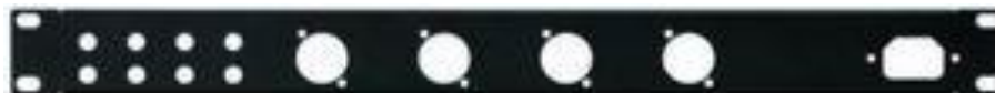
RCP-8719U CHAPA RACK CONECTORES DE HIERRO CON 1 UNIDAD 4 XLR-SPEAKON tipo-D, 8 RCA, 1 IEC-320 ANCHURA : 483 mm ALTURA : 44.5 mm
