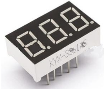
LED07X3AC/RO DISPLAY 3 X 7 SEG. ANODO COMUN 0.56" ROJO 12 PIN
