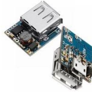
TP5400 Micro USB + USB Módulo de carga Li-ION 3V7 1 A Protección de Carga, Sobrecorriente y Descarga
