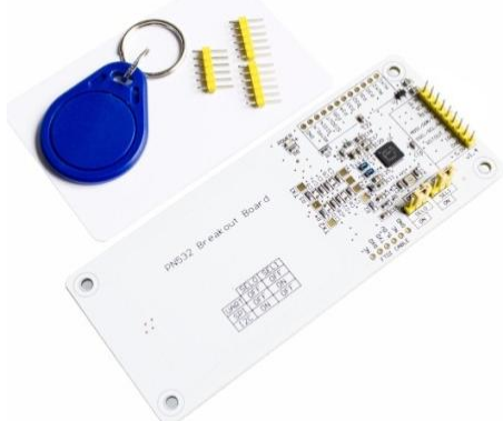
MD9028 MODULO RFID/NFC LECTOR 13.56 MHZ PN532 CON TARJETA Y TAG
