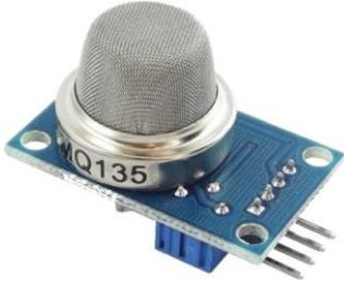
Sensor implementado en la detección de gases peligrosos y en controladores de la calidad del aire. Este sensor es capaz de detectar un amplio rango de gases que incluye: NH<sub>3</sub>, NO<sub>x</sub>, alcohol, Benceno, Humo y CO<sub>2</sub>.
