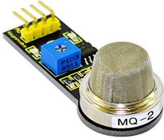
Sensor con una afinidad a la mediciones de GAS (propano y CO<sub>2</sub>), modulo con salidas analógica
