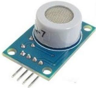
El sensor de monóxido de carbono MQ-7 está especialmente diseñado para ser sensible al gas monóxido de carbono (CO) que emiten los vehículos, las fábricas, etc. Dado que este gas se considera tóxico para los humanos en ciertos niveles, la concentración de CO se utiliza para determinar la Contaminación del aire en un área determinada.
