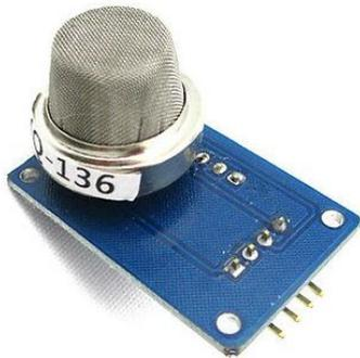
Cuando existe el gas de sulfuro de hidrógeno objetivo, la conductividad del sensor es mayor junto con el aumento de la concentración de sulfuro de hidrógeno. Utilice un circuito eléctrico simple, convierta el cambio de conductividad en la señal de salida correspondiente de la concentración de gas. El sensor de gas MQ136 tiene alta sensibilidad al sulfuro de hidrógeno, baja sensibilidad para otros gases combustibles.
