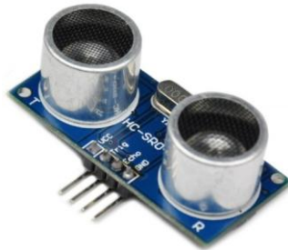
MD0017 MODULO SENSOR ULTRASONIDOS HC-SR04
