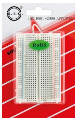
Código: BP001 Fabricante: EIC Ref. Fabricante: EIC801 Numero Puntos : 400
