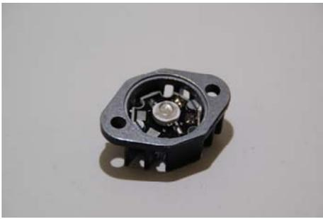
Detalle del Power Led 3 w montado en un disipador exterior TO3
